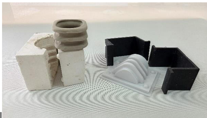
IMAGEN 4. Maceta de cerámica: pieza colada de cerámica, moldes de yeso, caja de moldeo y matriz impresa en PLA. Proyecto de Gorosito y Veiras.
